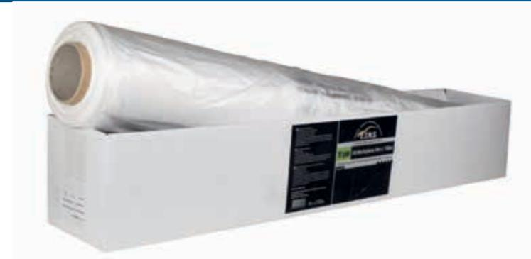
Используется при проведении окрасочных работ. Предназначена для маскирования не подлежащих окраске деталей кузова автомобиля. Обладает статическими свойствами, что позволяет ей плотно прилипнуть к поверхности и обеспечивать эффективное маскирование. После проведения окрасочных работ краска и грунт с пленки не отшелушиваются. Состав 100% полиэтилен. Толщина 11  $\mu\text{m}$ . Размер в рулоне 4x150м.
